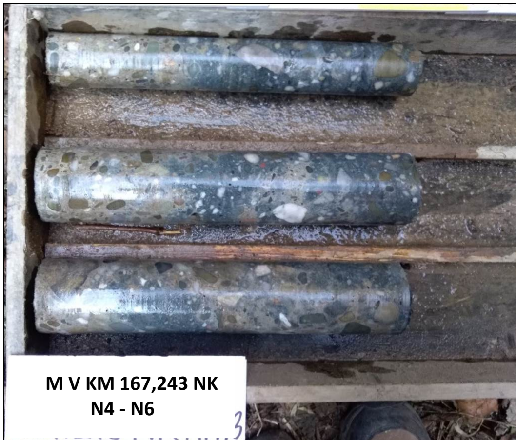
Obr. č. 2 - diagnostické návrty do nosné konstrukce N4 – N6
